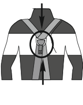
Рис. 7. Правильное положение страховочной точки А на спине
